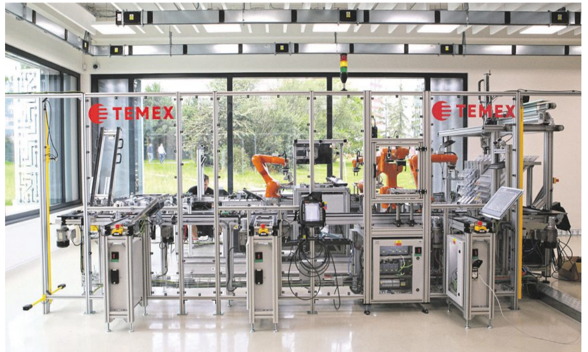
Výuková výrobní linka. Montážní linku pro automatickou a manuální montáž výrobků pro nový studijní program strojní fakulty VŠB – Technické univerzity Ostrava připravila firma Temex. Foto: Temex – Bohdan Dvořák
