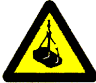
Pozor na zavěšené břemeno
