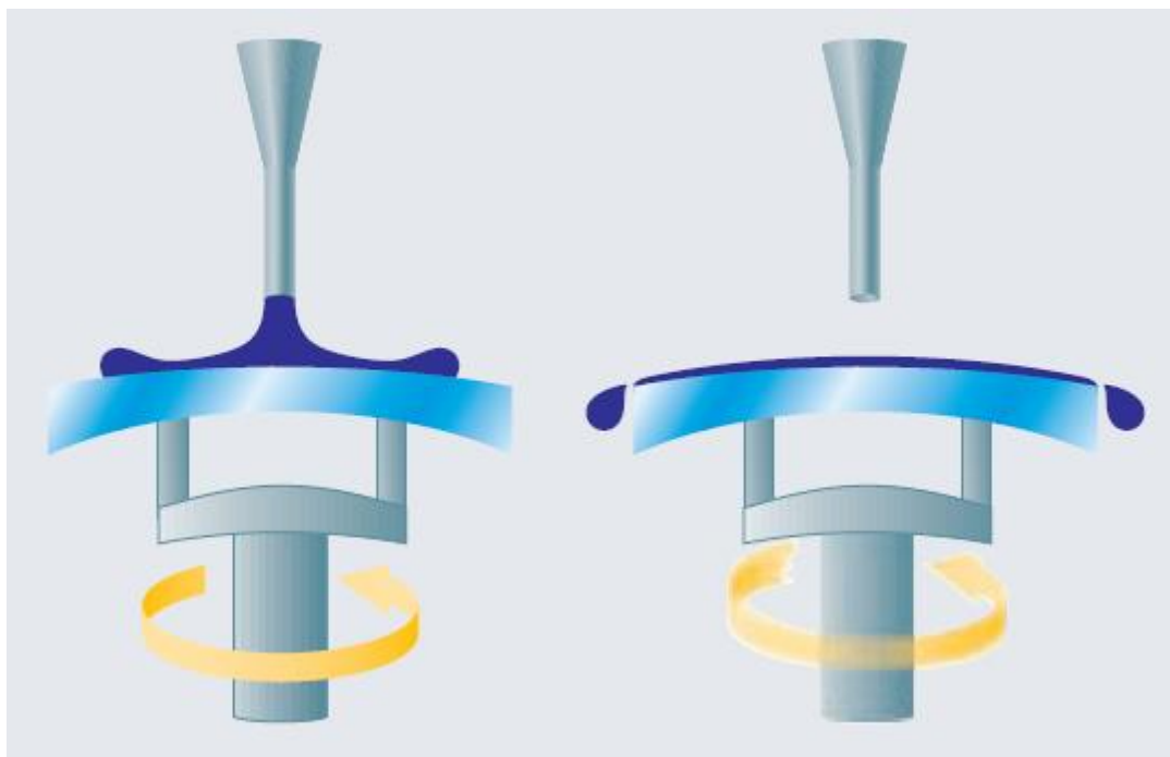
Obr. č. 2: Nanášení laku metodou spin coating. [1]
