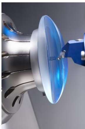
Obrázek 1: Ukázka zpracování čočky přístrojem Satisloh
