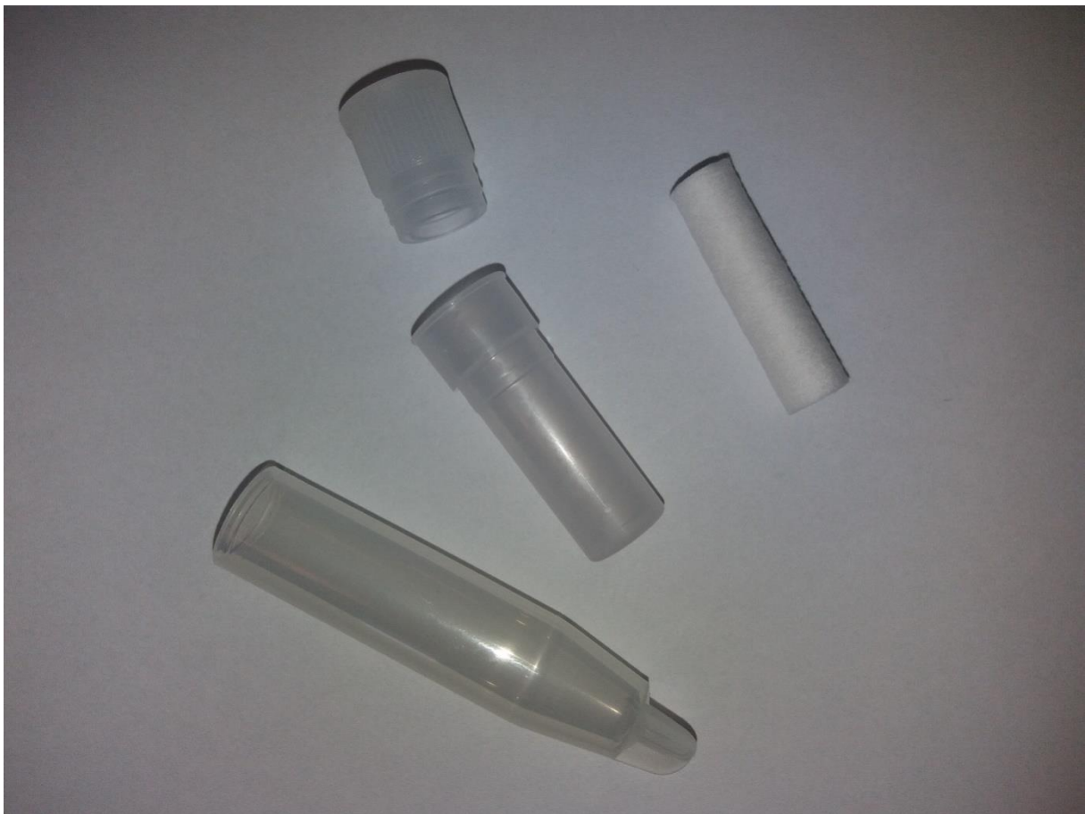
Obr. 7 10 ml uzavíratelná zkumavka Salivette (Sarstedt) s bavlněným žvýkacím válečkem určená k odběru stimulované sliny
