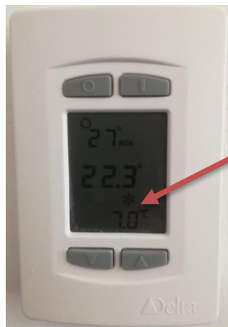
Obr. 2 - Vizualizace stavu otevření okna (7.0°C)
