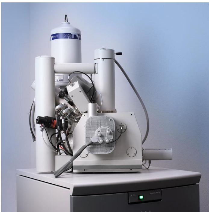
Tiskové foto č. 1: Elektronový mikroskop Quanta 3D 200i Zdroj: FEI Company
