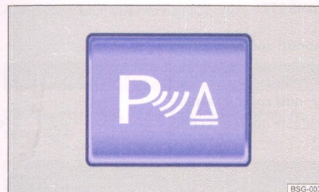
Obr. 126 Ve středové konzole: tlačítko pro zapnutí nebo vypnutí systému pomoci při parkování (v závislosti na výbavě).
