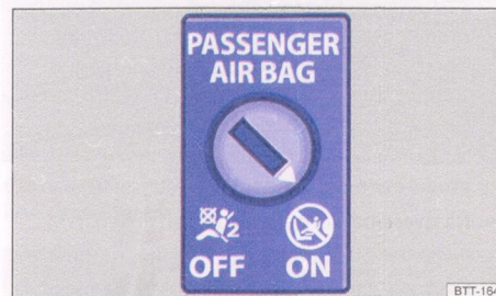
Obr. 40 Na čelní straně přístrojové desky: zámkový vypínač k vypnutí a zapnutí čelního airbagu na straně spolujezdce
