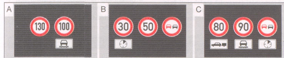
Obr. 20 Na displeji sdružených přístrojů: příklady rozpoznávaných příkazových rychlostí a zákazu předjíždění s příslušnou doplňkovou značkou.
