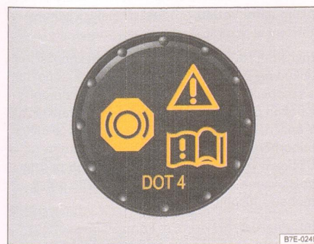
Obr. 189 V motorovém prostoru: uzávěr nádržky brzdové kapaliny.
