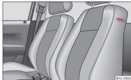
Obr. 121 Umístění bočních airbagů v sedadle řidiče
