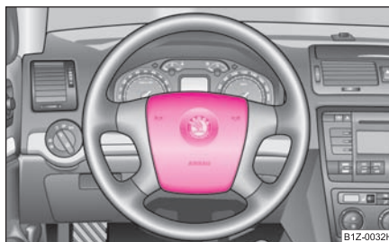
Obr. 117 Airbag řidiče ve volantu
