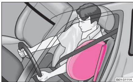
Obr. 122 Plynem naplněné boční airbagy
