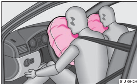
Obr. 119 Plynem naplněné airbagy
