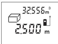
Після закінчення третього вимірювання прилад автоматично розраховує об'єм і показує результат. Останнє одиничне виміряне значення показується внизу на дисплеї, кінцевий результат знаходиться угорі.
