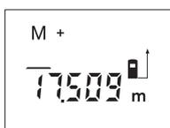
Dodawanie poszczególnych pomiarów – odległości, powierzchni lub objętości (w zależności od aktualnie ustawionej funkcji pomiaru) – do pamięci, odbywa się przez naciśnięcie przycisku dodawania wartości do zawartości pamięci **4**.
