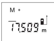
Stlačte tlačítko přičítání k paměti **4**, aby se aktuální naměřená hodnota – podle aktuální měřicí funkce hodnota délky, plochy nebo objemu – uložila do paměti. Jakmile se hodnota uložila, objeví se na displeji „M“, znak „+“ za ním krátce zabliká.
