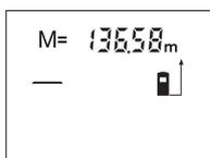
Stlačte tlačidlo na vyvolanie pamäte **11**, aby sa zobrazila hodnota, ktorá je uložená v pamäti. Na displeji sa zobrazí symbol pamäti „M=“. Keď sa na displeji zobrazí obsah pamäte „M=“, môžete ho stlačením pripočítavacieho tlačidla pamäte **4** zdvojnásobiť, resp. stlačením odpočítavacieho tlačidla pamäte **3** zredukovať na nulu (vynulovať).
