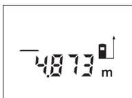
Stlačte tlačítko měření **9** jednou k zaměření a znovu pro změření.
