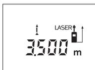
Pritisnite taster merenje **9** za pokretanje merenja. Pokrećite merni alat toliko dugo, sve dok se dole na displeju ne pokaže željena vrednost rastojanja.
