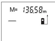
Для отображения сохраненного значения нажмите кнопку вызова из памяти **11**. На дисплее высвечивается «**M**=». При отображении на дисплее сохраненного значения «**M**=» Вы можете, нажав кнопку сложения **4**, умножить его на два или, нажав кнопку вычитания **3**, обнулить содержимое памяти.
