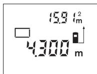
По окончании второго измерения площадь автоматически рассчитывается и высвечивается на дисплее. Последнее единичное измеренное значение высвечивается на дисплее внизу, а конечный результат – вверх.
