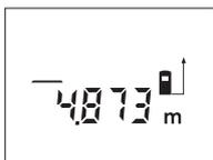
Натисніть на кнопку вимірювання **9** один раз для наведення на ціль і ще один раз для вимірювання.
