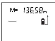
Pritisnite tipko za odčitavanje pomnilnika **11** in odčitajte vrednost, ki je shranjena v njem. Na zaslonu se prikaže „M“. Ko je na zaslonu prikazana vsebina pomnilnika „M“, jo lahko s pritiskanjem tipke za shranjevanje in prištevaje **4** podvojite oziroma s pritiskanjem tipke za shranjevanje in odštevanje **3** spravite na ničlo.
