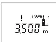
Stlačte tlačidlo Meranie **9**, aby ste spustili meranie. Merací prístroj pohybuje dovedy, kým sa dole na displeji zobrazí požadovaná hodnota vzdialenosti.
