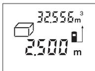
По окончании третьего измерения объем автоматически рассчитывается и высвечивается на дисплее. Последнее единичное измерение высвечивается на дисплее внизу, а конечный результат – вверх.
