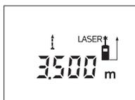
Pro spuštění procesu měření stlačte tlačítko měření **9**. Pohybuje měřícím přístrojem tak dlouho, až se dole na displeji zobrazí požadovaná hodnota vzdálenosti.
