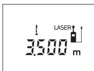
Чтобы начать процесс измерения, нажмите кнопку измерения **9**. Передвигайте измерительный инструмент, пока внизу на дисплее не отобразится желаемое расстояние.
