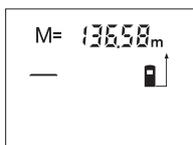
Pritisnite tipku za pozivanje memorije **11**, za pokazivanje vrijednosti koja se nalazi u memoriji. Na displeju se pojavljuje „M“. Ako se na displeju pokaže sadržaj memorije „M“, tada ga pritiskom na tipku memorije za zbrajanje **4** možete podvostručiti, odnosno pritiskom na tipku memorije za oduzimanje **3** svesti na nulu.
