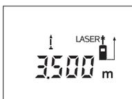
A mérési folyamat kiváltásához nyomja meg a **9** mérési billentyűt. Mozdassa el addig a mérőműszert, amíg a kijelző alsó részén meg nem jelenik a kívánt távolságérték.
