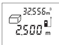
Nakon isključivanja trećeg mjerenja, automatski će se izračunati i pokazati volumen. Zadnja pojedinačna izmjerena vrijednost nalazi se dolje na displeju, a krajnji rezultat gore.
