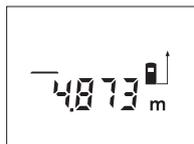
За насочване на лазерния лъч натиснете еднократно бутона «Измерване» **9**, а за измерване го натиснете повторно.
