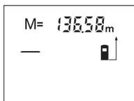
Lai uz displeja nolasītu mērinstrumenta atmiņā ierakstīto vērtību, nospiediet atmiņas satura nolasišanas taustiņu **11**. Uz displeja parādās atmiņas satura nolasišanas indikators „**M**=“. Ja uz displeja ir redzams atmiņas satura nolasišanas indikators „**M**=“, tad, nospiežot pieskaitīšanas taustiņu **4**, atmiņas saturs divkāršojas, bet, nospiežot atņemšanas taustiņu **3**, atmiņas saturs kļūst vienāds ar nulli.
