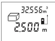
Pärast kolmanda mõõtmise teostamist arvutatakse ruumala automaatselt välja ja kuvatakse ekraanile. Viimase üksiku mõõtmise väärtust näidatakse ekraani alumises osas, lõpptulemust ülemises osas.
