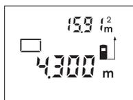
Nakon završenog drugog mjerenja, automatski će se izračunati i pokazati površina. Zadnja pojedinačna izmjerena vrijednost nalazi se dolje na displeju, a krajnji rezultat gore.
