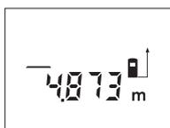
Jeden raz stlačte tlačidlo meranie **9** na zameranie laserového lúča a potom znova na vykonanie merania.
