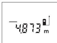
Нажмите кнопку измерения **9** один раз для наведения и еще один раз для выполнения измерения.
