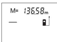
Stlačte tlačítko vyvolání paměti **11**, aby se v paměti uložená hodnota zobrazila. Na displeji se objeví „M=“. Pokud je na displeji zobrazen obsah paměti „M=“, pak jej můžete stlačením tlačítka přičítání k paměti **4** zdvojnásobit ev. stlačením tlačítka odčítání od paměti **3** stanovit na nulu.
