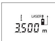
За стартиране на процеса на измерване натиснете бутона «Измерване» **9**. Придвижвайте измервателния уред, докато в долната част на дисплея се изобрази желаното разстояние.
