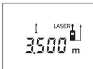
Proces pomiaru rozpoczyna się po naciśnięciu przycisku pomiaru **9**. Poruszać urządzeniem pomiarowym dotąd, aż u dołu wyświetlacza ukaze się żądana odległość.
