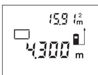
Pärast teise mõõtmise teostamist arvutatakse pindala automaatselt välja ja kuvatakse ekraanile. Viimase üksiku mõõtmise väärtust näidatakse ekraani alumises osas, lõpptulemust ülemises osas.
