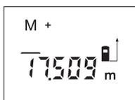
Lai ierakstītu mērinstrumenta atmiņā pašreizējo mērījuma rezultātu, kas iegūts garuma, laukuma vai tilpuma mērīšanas režīmā, nospiediet pieskaitīšanas taustiņu **4**. Ierakstot mērījuma rezultātu atmiņā, uz displeja parādās atmiņas satura indikators „**M**“ un īslaicīgi kļūst redzams apzīmējums „+“.
