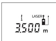
Щоб розпочати вимірювання, натисніть на кнопку вимірювання **9**. Пересувайте вимірювальний прилад до тих пір, поки внизу на дисплеї не висвітлиться необхідна відстань.
