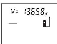
Aby wyświetlić wartość znajdującą się w pamięci należy nacisnąć przycisk edycji zapisanych danych **11**. Na wyświetlaczu ukaże się symbol „**M**”. Po ukazaniu się zawartości pamięci „**M**=” na wyświetlaczu, można naciskając przycisk dodawania wartości do zawartości pamięci **4** wartość tę podwoić lub naciskając przycisk odejmowania wartości od zawartości pamięci **3** wyzerować.
