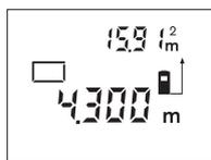
Pēc otrā mērījuma beigām laukuma mērījuma rezultāts tiek automātiski aprēķināts un parādīts uz displeja. Pēdējā atsevišķā mērījuma rezultāts parādās uz displeja apakšējā indikatora, bet aprēķinātā laukuma vērtība ir redzama uz indikatora displeja augšējā daļā.
