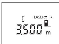
Lai uzsāktu mērīšanu, nospiediet mērīšanas taustiņu **9**. Pārvietojiet mērinstrumentu, līdz displeja apakšējā daļā parādās vēlamā attāluma vērtība.
