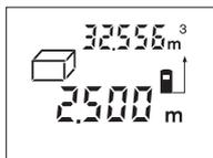
Pēc trešā mērījuma beigām tilpuma mērījuma rezultāts tiek automātiski aprēķināts un parādīts uz displeja. Pēdējā atsevišķā mērījuma rezultāts parādās uz displeja apakšējā indikatora, bet aprēķinātā tilpuma vērtība ir redzama uz indikatora displeja augšējā daļā.
