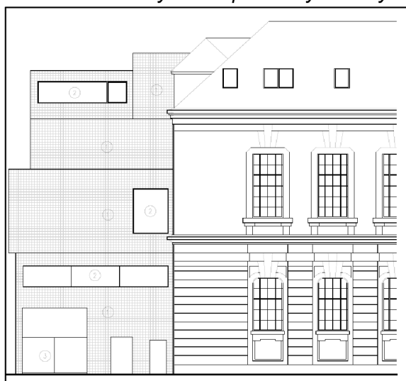
Architektonický návrh přístavby budovy
