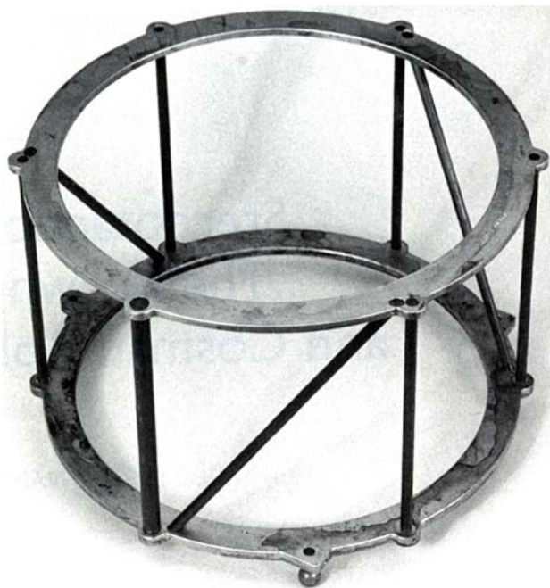
Obr.7 Příklad uspořádání zaměřovacích markerů ve tvaru písmene N - převzato z (1).
