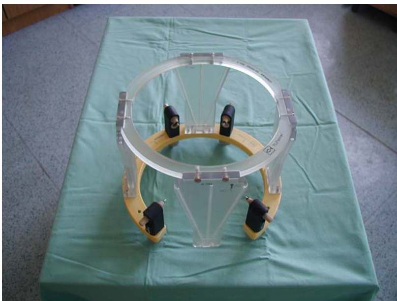
Obr.8 Příklad uspořádání zaměřovacích markerů do tvaru písmeno V.
