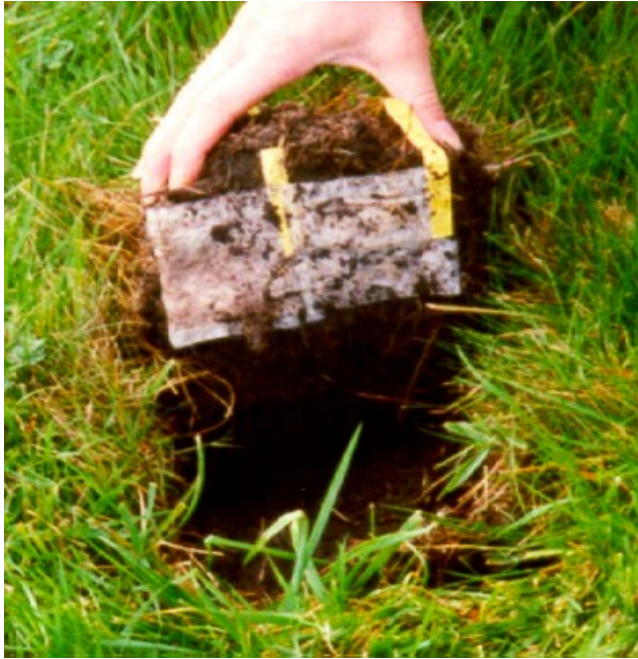
Obr. 6. Ukázka techniky zakopaných sáčků se substrátem (buried litter bags)
