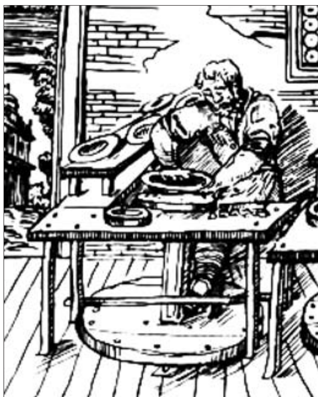
Obr. 3.2:5 Hrnčírská dílna. Hrnčír vyrábí hluboké pánve k pražení rudy obsahující pyrit. Pražicí pec v pozadí. Vyobrazení z Agricolyvy knihy „De re metallica“, 1556 (podle www.sandragon.cz).
