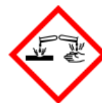
GHS05 – korozivní a žíravé látky
