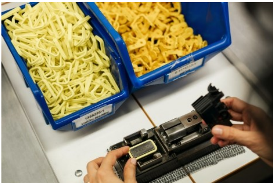
Obr. 3: Montáž autodílů a těsnění
