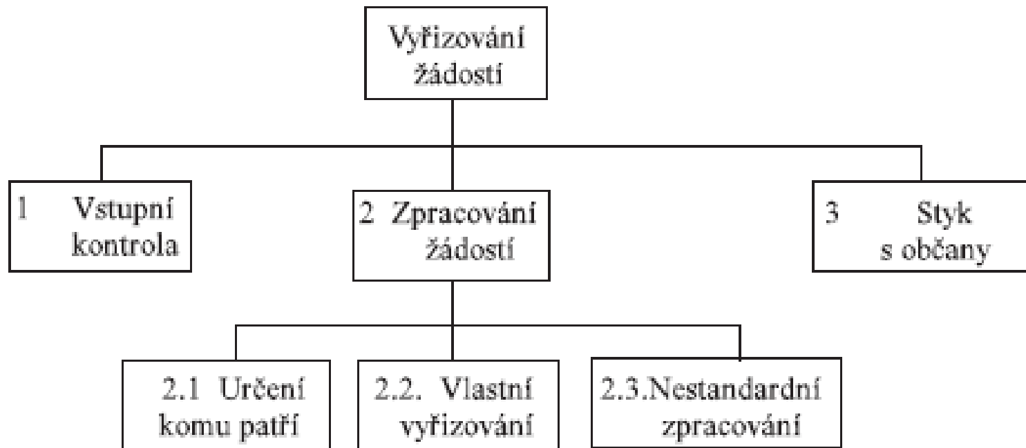
Obr. 12.11: Hierarchie vytvořená postupnou dekompozicí systému Zpracování žádostí.
