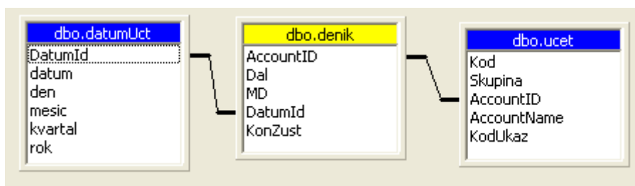
Obr.č.7 Příklad hvězdicového schématu (žlutě tabulka faktů)
