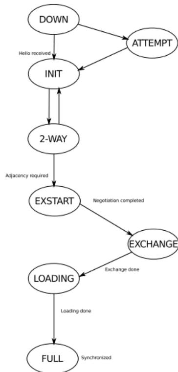
2-way – směrovač obdržel Hello paket, který obsahuje RID tohoto směrovače. Směrovače jsou nyní sousedé. Nastává volba DR a BDR. Ve stavu 2-way zůstává směrovač se všemi ostatními směrovači s výjimkou DR a BDR.
