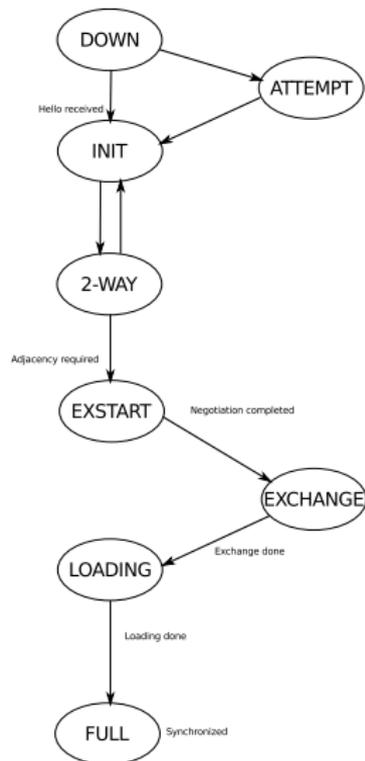
Loading – výměna směrovacích informací pomocí Link State Request a Link State Update zpráv
