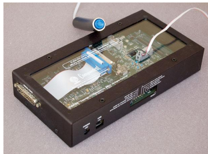
Karta v DTE doplněná PTT zařízením (PTT – Push to Talk resp. Press-to-Transit, určeno pro HDX)
