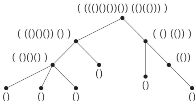
**Kód** uspořádaného kořenového stromu se spočítá rekurzivně z kódů všech podstromů kořene, seřazených v daném pořadí a uzavřených do páru závorek. □
