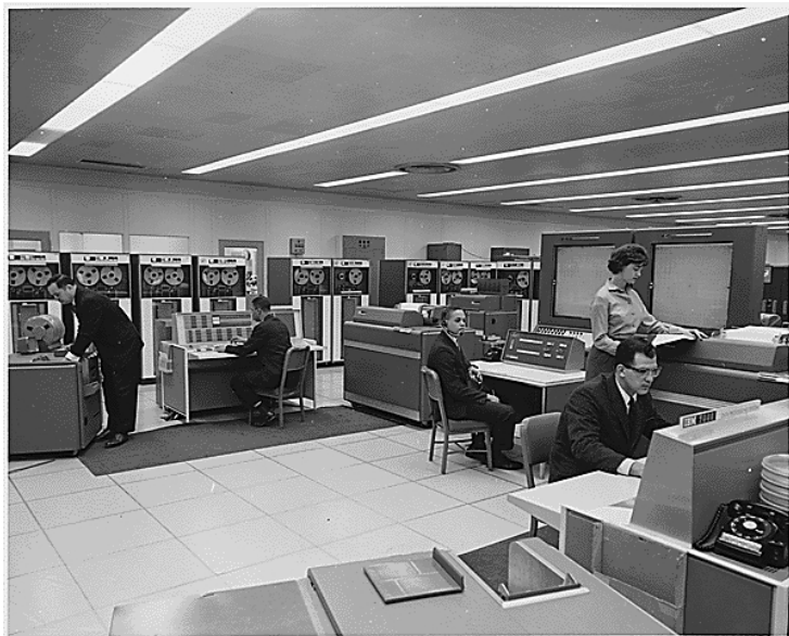
IBM 7090 využívaný NASA v projekte Mercury Zdroj: http://en.wikipedia.org
