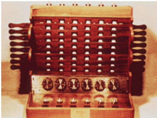
Replika Schickardova kalkulátoru
