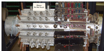
Zpoždovací linka počítače UNIVAC I Zdroj: http://en.wikipedia.org
