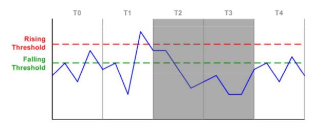
Switch(config-if)# storm-control broadcast level bps 1m 500k stormcontrol v b/s je podporováno pouze na zařízeních 3850 & IOS XR, jinak nesmyslná procenta.
