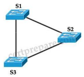
Např. v topologii výše předpokládejme, že S1 je aktuální kořenový most. Pokud hacker připojí přepínač na S3, který vysílá lepší BPDU, stane se novým kořenovým mostem, také to změní dopravní cestu a může vést k dopravní zácpě. Povolením root guard na portu S3 výpočty spanning-tree způsobí, že místo aby bylo rozhraní vybráno jako root port, přejde do stavu nekonzistentního (zablokovaného) root, aby se zabránilo hackerskému přepínači stát se rootovým přepínačem nebo být cestou ke kořenu.
