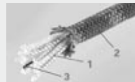
1 - pramen 2 - oplet 3 - vlákno označující rok výroby lana (každý rok jiná barva)
