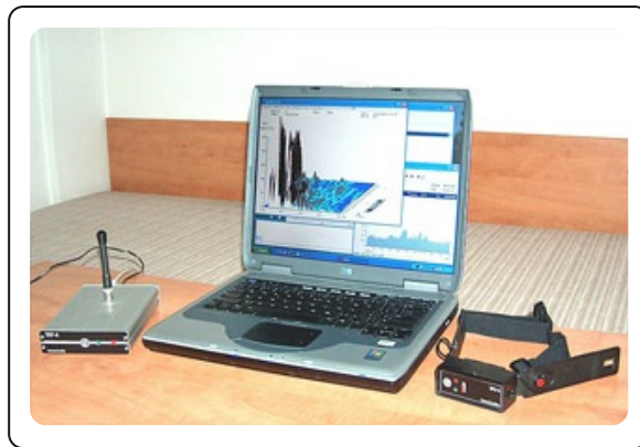
OBR.25 SYSTÉM PRO MĚŘENÍ A ANALÝZU R-R INTERVALŮ VARIA CARDIO TF4 Zdroj: archiv autora
