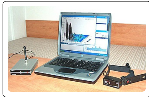
OBR.4 SYSTÉM PRO ANALÝZU VARIABILITY SRDEČNÍ FREKVENCE VARIACARDIO TF4-VPRAVO HRUDNÍ PÁS S ELEKTRODAMI A VYSÍLAČKOU, VLEVO PŘIJÍMAČ Zdroj: archiv autora
