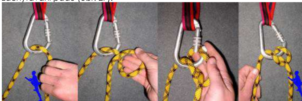
obr. 27 – Zakládání polovičního lodního uzlu do karabiny HMS
