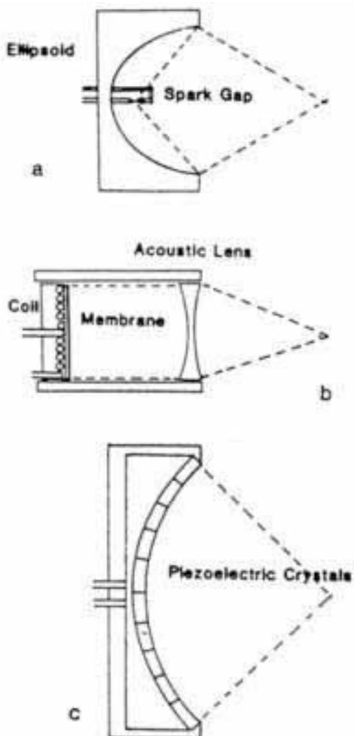
Přístroj mění vzduchovou vlnu, která je vytvářena dle přístroje tlakem 0,5 - 5 barů v akustickou radiální vlnu event. elektromagneticky od 60 mJ do 185 mJ.
