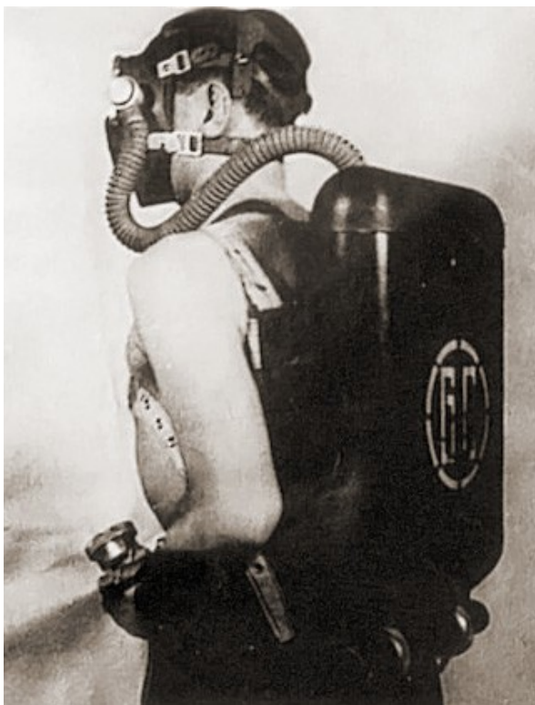
Obr. 27. GC 42, první nezávislý potápěčský přístroj, Amphibie, autor Georgese Commeinhese 1942
