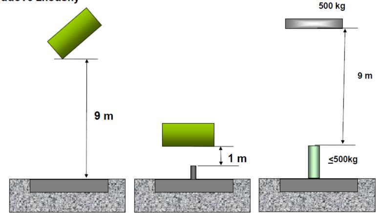
Zkoušky prokazující schopnost přestát podmínky nehody při přepravě
