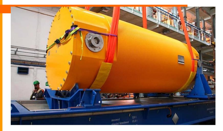
Zkoušky prokazující schopnost přestát podmínky nehody při přepravě Pádové zkoušky
