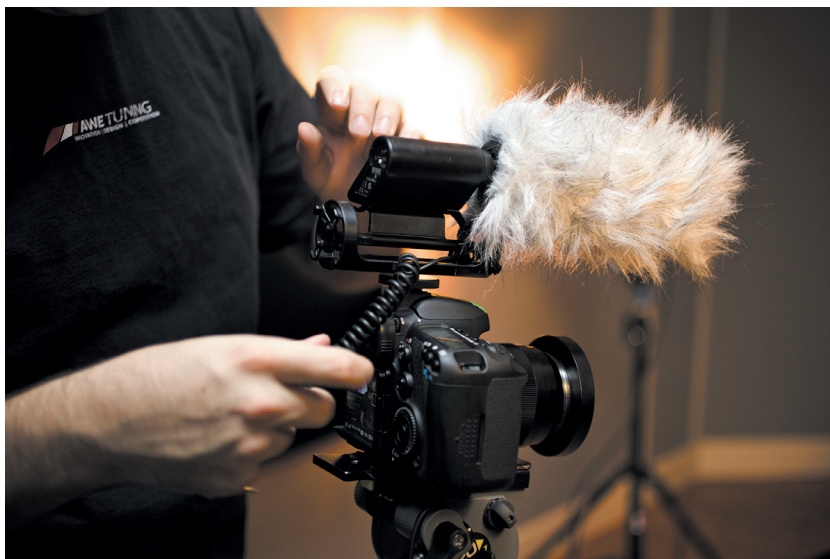
OBRÁZEK 9.1: Mikrofon typu shotgun (puška) připevněný k vašemu fotoaparátu zachytí zvuky prostředí daleko lépe než vestavěný mikrofon. Je šikový, protože nahrává zvuky z místa, kde je fotoaparát umístěný.
