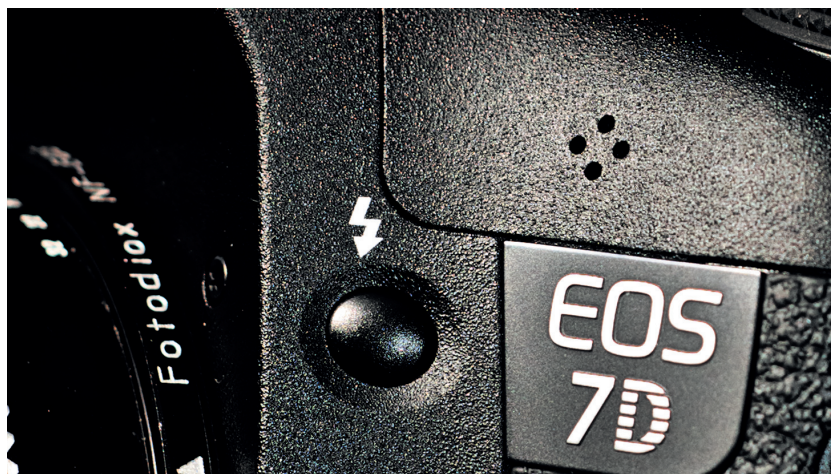
OBRÁZEK 9.3: Vestavěný mikrofón DSLR fotoaparátů je, pokud vám jde o kvalitní audio, v podstatě nepoužitelný. Využijete ho pro zachycení orientačního a záložního zvuku, ale to je tak vše.
