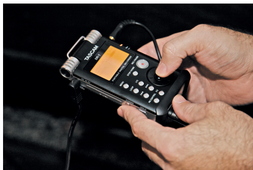
OBRÁZEK 9.2: Externí audiorekordér nabízí mnoho voleb, včetně kanálů, vzorkovací frekvence a formát souboru.
