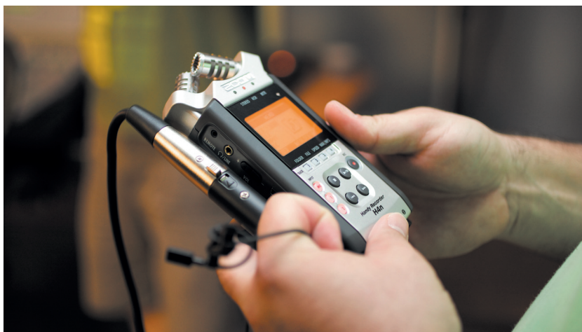
OBRÁZEK 9.8: Ruční rekordéry mají snadno přístupné ovládací prvky a ukazatele úrovní, podle kterých můžete sledovat a upravovat úroveň záznamu. Foto: Lisa Robinson.
