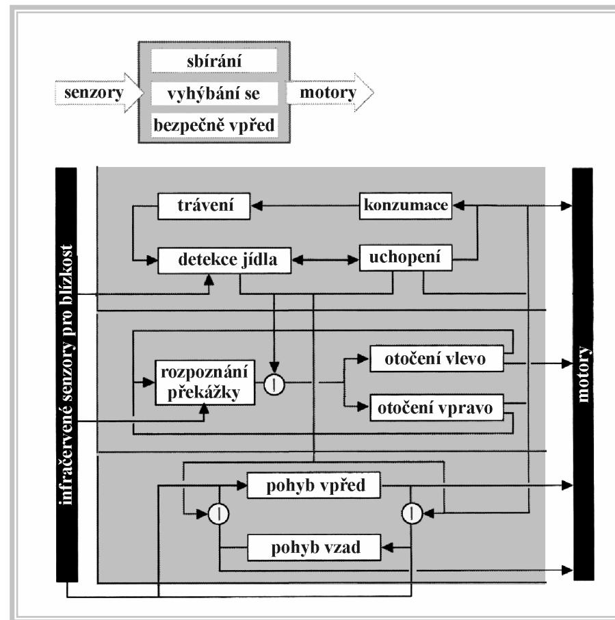
V subsumpční architektuře je vrstva komponována jako soubor modulů. Každý modul je tvořen **rozšířeným strojem s konečným počtem stavů** (speciální *finite state automata*)
