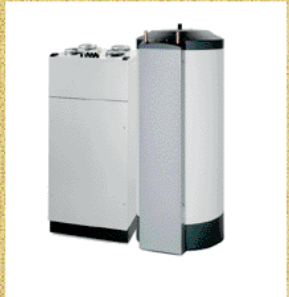
Kompaktní zařízení s tepelným čerpadlem a zásobníkem určené pro pasivní dům. Veškerá domovní technika pro vytápění, přípravu teplé vody a větrání je integrována do jediného kompaktního přístroje velikosti mrazničky. Na tepelný zásobník v pravé části obrázku může být dále připojen solární systém
