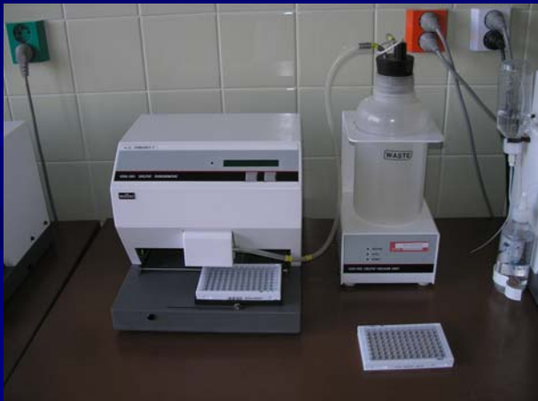
4 Odstranění terčků z jamek (vakuová odsávačka)
