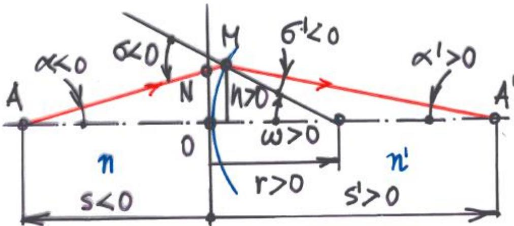
**Paraxiálním paprskem** je označován paprsek, který se šíří z osového bodu předmětu pod malým úhlem  $\alpha$  a optickou soustavu protíná v malé dopadové výšce  $h$ .
