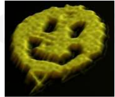
Reliér vytvořený plošnou strukturou DNA, výška vrstvy 2-4 nm (Nick Papadakis, P.W.K.R)
