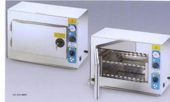
Horkovzdušný sterilizátor se po skončení sterilizačního cyklu otevírá až po zchladnutí alespoň na 80°C.
