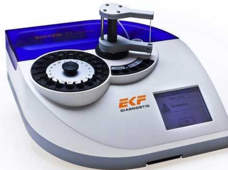
□ automatický stolní analyzátor ke stanovení glukózy a laktátu (Biosen)
