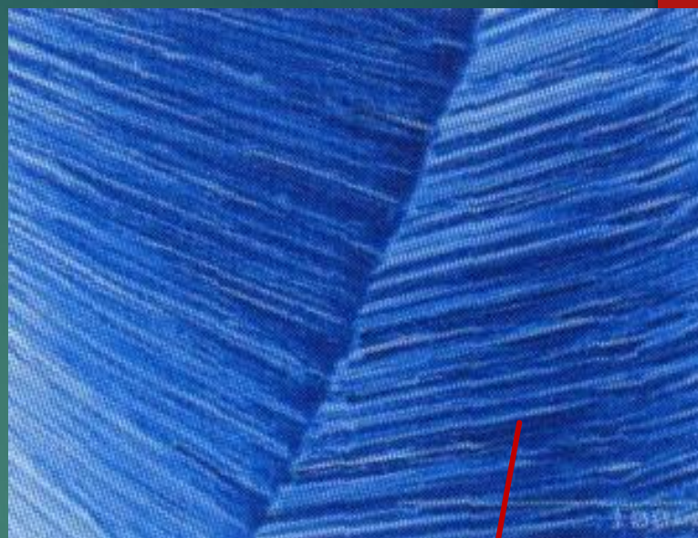
Rýhy po frézování nástroje
