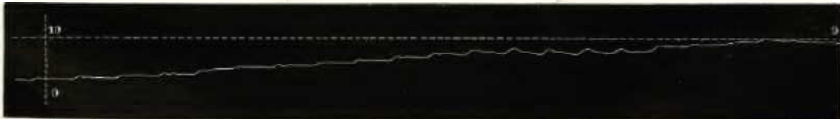
Fig. 153. — Inscription manométrique des changements de volume de l'ampoule d'un sphygmoscope soumise à des pressions extérieures variant de zéro à centimètres de mercure.
