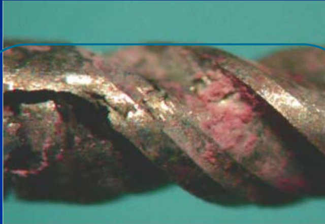
Abb. 4 ▲ Nickel-Titan-Instrument mit Rückständen nach klinischer Anwendung trotz Durchführung eines Reinigungsprotokolls zur Prionendekontamination
