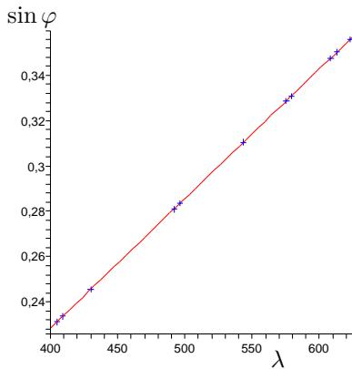
Určete materiálové konstanty skla použitého na výrobu měřeného hranolu. Pro vybrané spektrální čáry rtuťové výbojky byly určeny následující hodnoty indexu lomu skleněného hranolu, k proložení naměřených dat použijte Cauchyův vztah  $n = a + \frac{b}{\lambda^2} + \frac{c}{\lambda^4}$ .
