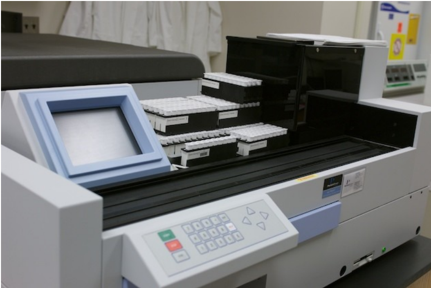
Vysoce kapacitní gamačítač: PerkinElmer Wizard 1470 10 kanálový, vysoká kapacita pro měření vzorků
