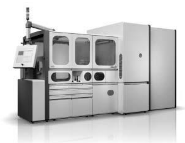
Obr.11 Skladový modul p501 ze systému Modular Preanalytics, Roche Funkce: ukládá 400 zkumavek/hod. automaticky zátkuje a odzátkovává likviduje vzorky po uplynutí expirace kapacita 13500 zkumavek
