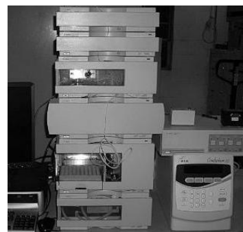
Obr. 69, 70: Záznam analýzy katecholaminů v moči z HPLC Agilent série 1200, elektrochemický detektor Coulochem
