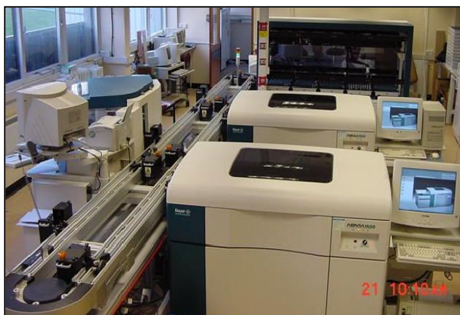
Obr.8 Systém ADVIA LabCell, spojený s dvěma automatickými analyzátory Advia 1600 a imunochemickým analyzátorem Advia Centaur, firma Siemens
