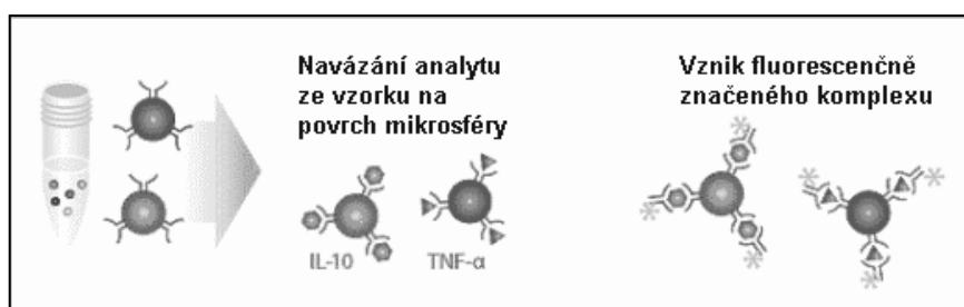
Obr.164: Princip multiplex. analýzy na mikrosférách
