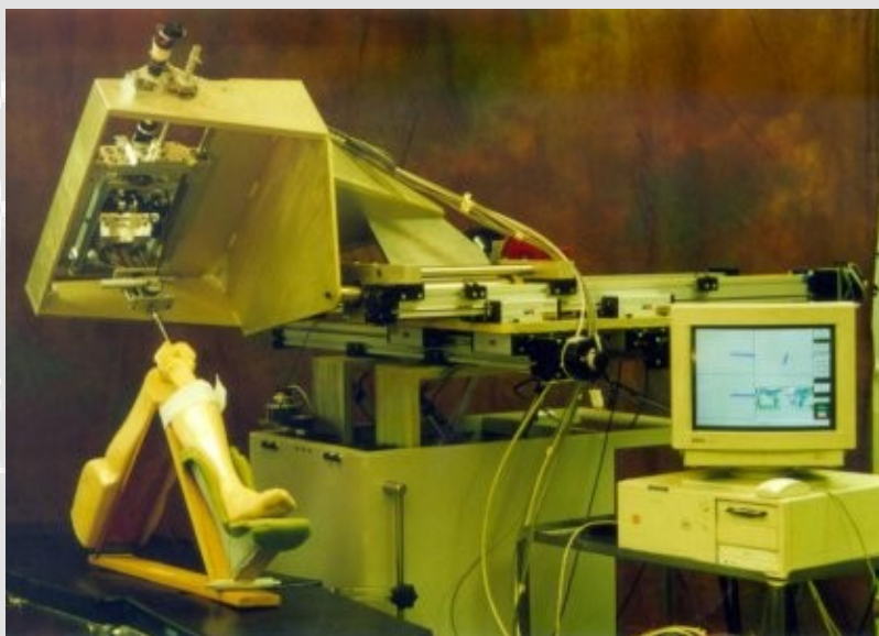
Robotické zařízení pro implantaci kolenní endoprotézy
