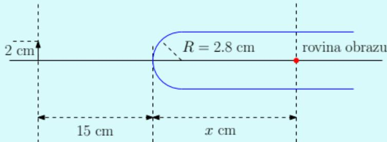
Systém je složen z volného prostoru s přenosovou maticí  $\begin{pmatrix} 1 & d \\ 0 & 1 \end{pmatrix}$ , sférického povrchu s přenosovou refrakční maticí
