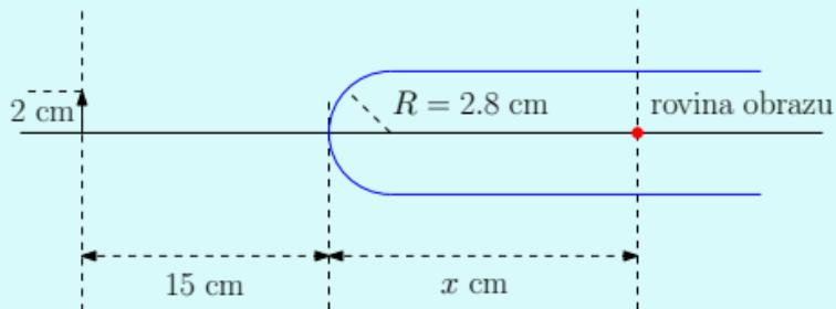
Plastová tyč s indexem lomu  $n = 1.56$  je ukončena sférickým povrchem o poloměru  $R = 2.8$  cm. Objekt vysoký 2 cm je umístěn ve vzdálenosti  $d = 15$  cm od tyče. Zjistěte umístění a velikost obrazu v tyči.
