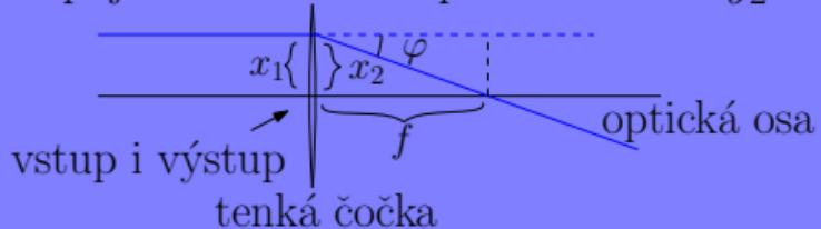
Napište zobrazovací rovnice a přenosovou matici pro tenkou čočku o ohniskové vzdálenosti  $f$ .
