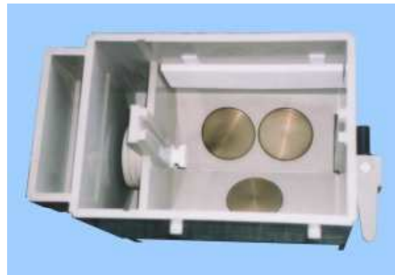
Ultrazvuková lázeň - pohled shora (okrouhlé destičky jsou zdroje ultrazvuku)
