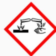
GHS05 - korozivní a žíravé látky
