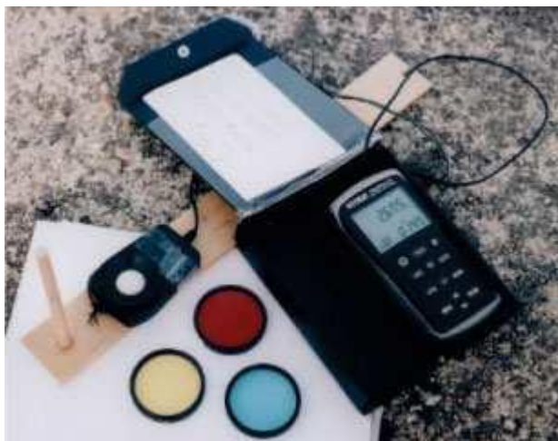
Obr. 1: Měřicí souprava: luxmetr, stínoměr, barevné fotografické filtry
